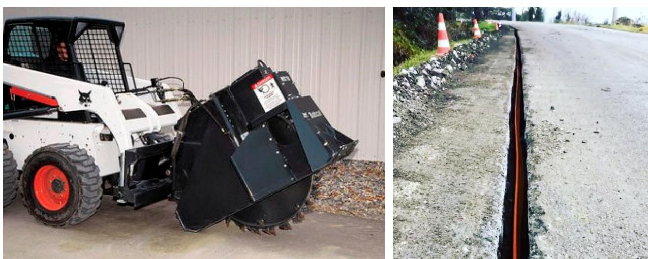
Figura 5 – Macchina operatrice per esecuzione di minitrincea
