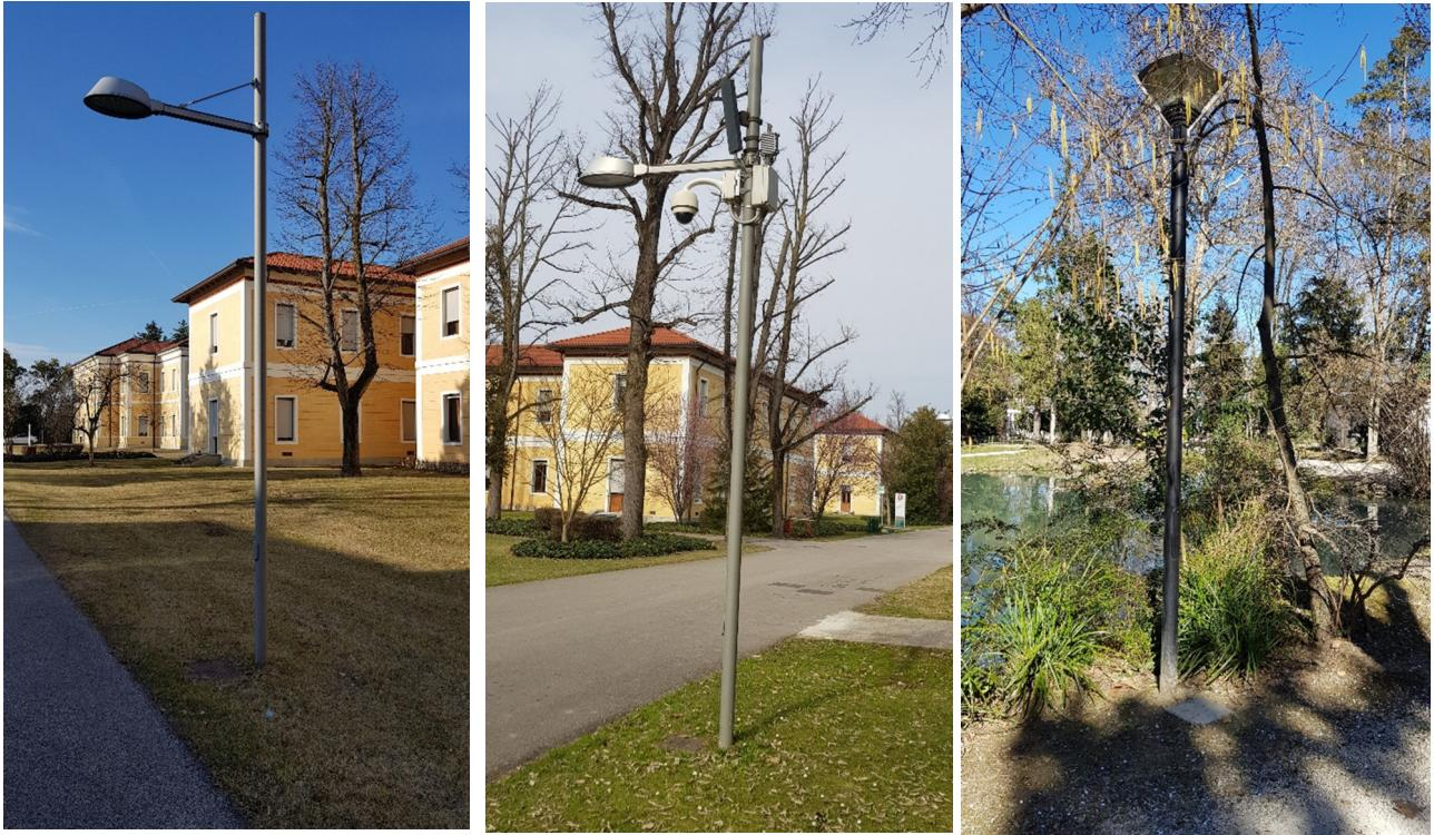
Figura 6 – Pali per IP idonei alla posa di telecamere. A destra una soluzione idonea la sito 6 Baia Grande.
